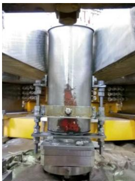
Рисунок 4 – Диагностика ИКВ в сборе с магнитным экраном на трековом патрубке КТМ
